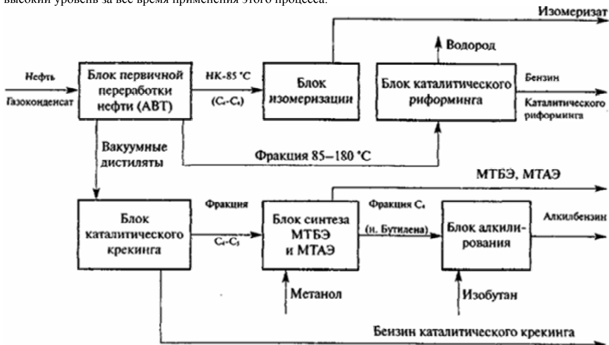
Рис. 1 Схема переработки нефти для получения автомобильных бензинов
